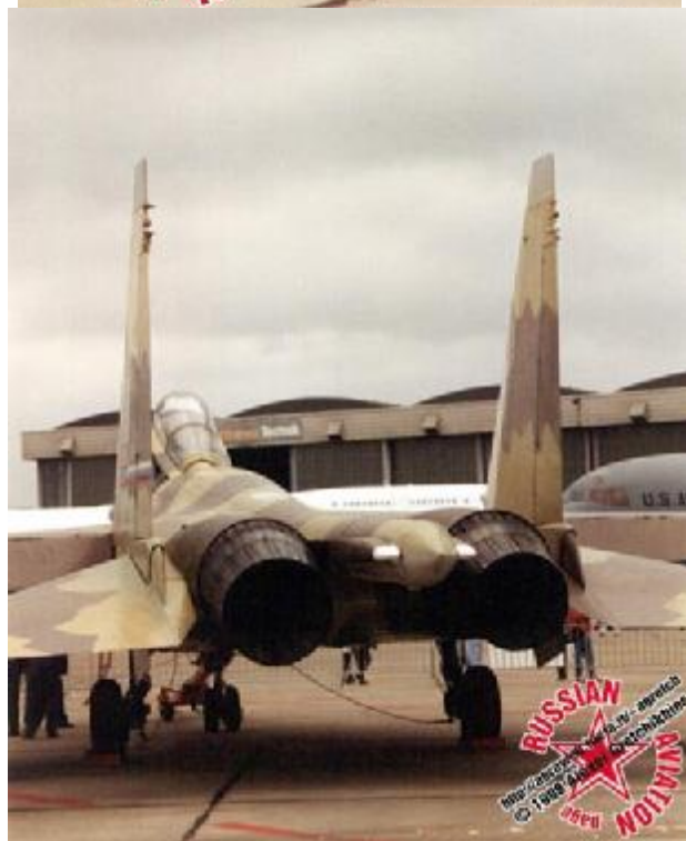
左：711 号苏-37，注意比较在机背天线后方，并没有苏-35 那样的凸起物。中：这位官员握住了苏-37 的机首顶尖，可以看到这没有空速管。右：苏-37 的矢量发动机喷管
